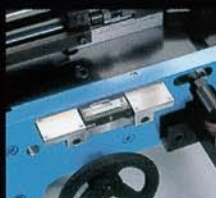
デジストローク Digital Stroke (The digital counter for stroke control)
