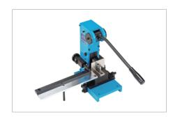
刃材両端を必要な形状 (ストレート or スミ切) に連続切断できます。 また、左右からのアテ切りもできます。 ※刃厚 O.9mm 以下の刃材の切断が可能。
